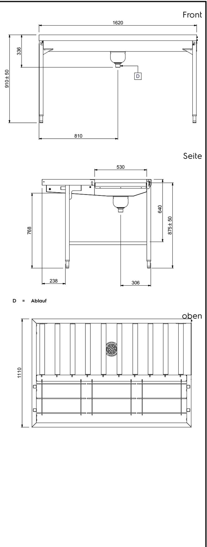
Handlingsystem für Korbtransportmaschinen
